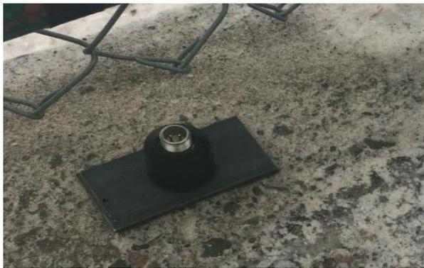
Fig 10. Piezometer Sensor
